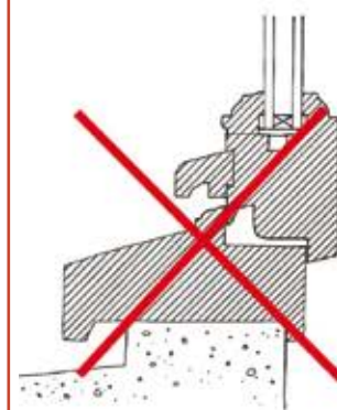
Profil moderne inadapté
